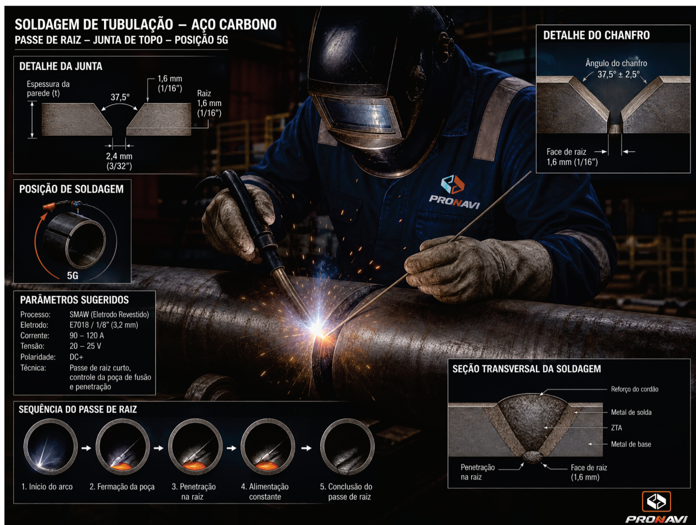
Figura 5.2: Detalhes da soldagem de tubulação em posição 5G.
