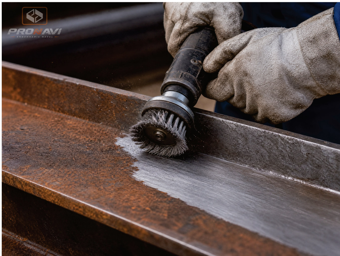
Figura 4.1: Exemplo de limpeza do metal base com escova de aço antes da soldagem.
